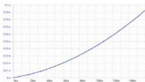
Fig. 2 : Trajet de chute en fonction du temps
