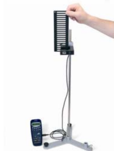
Fig.1 : Mesure de la chute libre
