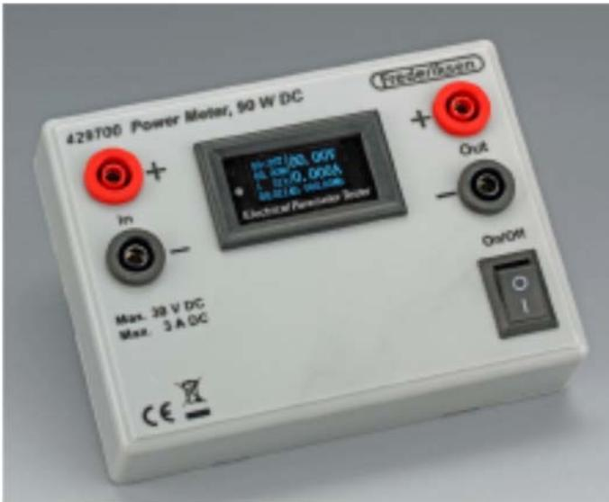
Le wattmètre est un instrument de mesure électrique polyvalent qui, en plus de la puissance, mesure la tension, le courant, l'énergie, la charge électrique et le temps. L'énergie mesurée est additionnée dans l'une des deux mémoires, il en va de même pour la charge électrique.
