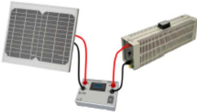
Connectez une cellule solaire à l'entrée du wattmètre. Ajustez l'inclinaison du panneau et positionnez-le face au sud.
