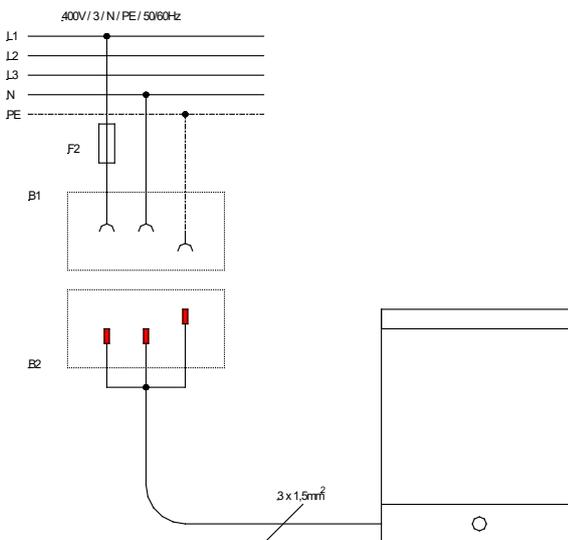
**13.1.3 Type 2008 en 230/1 à une alimentation 220V / 3 / PE / 50/60 Hz**
