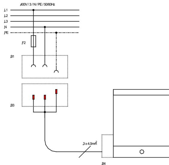
**13.1.5 Type 2008 et 2012 en réseau électrique 220/3 220V / 3 / PE / 50/60 Hz**
