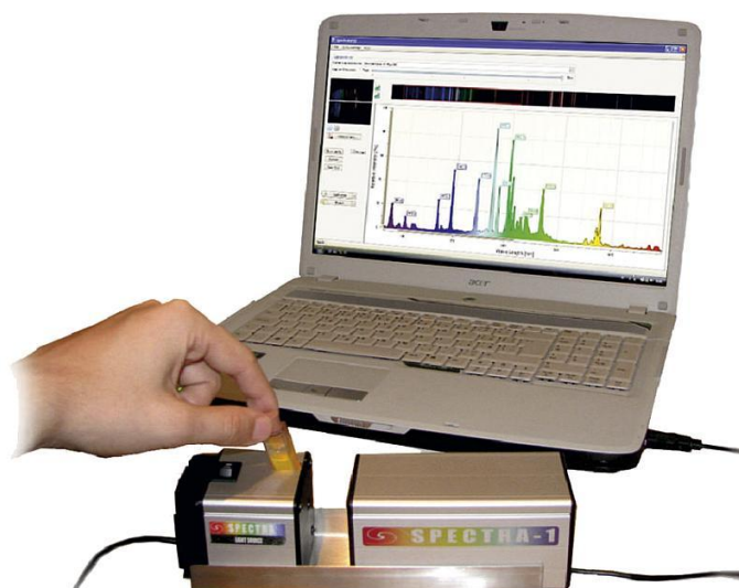
Source de lumière blanche Spectra connectée au Spectromètre
