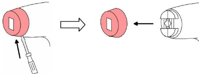
2. Retirez la manivelle de la génératrice. Pour cela, dévissez la vis Allen à l'aide de la clé hexagonale fournie dans le kit. La vis Allen peut de nouveau être utilisée dans le remontage.
