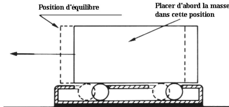
Soient alors  $\alpha$  l'angle que fait le rail avec le plan horizontal (lu sur le cadran gradué),  $F$  la masse suspendue au bout du fil (éventuellement, tenir compte de la masse du crochet) et  $P$  la masse du parallélépipède (pesé auparavant).
