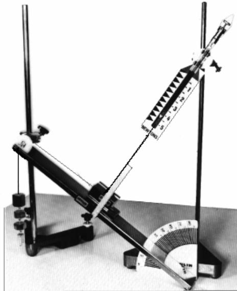
Montage simple réalisé avec 1 plan incliné, 1 dynamomètre de cours, 2 supports avec tiges, 2 noix de serrage, 1 boîte de masses à crochet.
