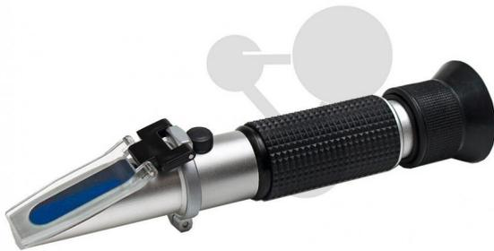
Réfractomètre analogique portable avec compensation automatique de la température et haute précision. Conception anti-bascule, oculaire confortable à ajustement parfait, prisme facile à nettoyer et couvercle de protection pour l'ouverture du prisme. Mesure du degré Brix. Comprend un étui avec tournevis et pipette.
