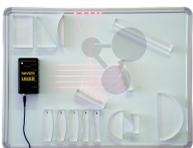
Ensemble optique magnétique avec laser et panneau
