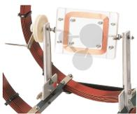
Bobine plate dans cadre rotatif
